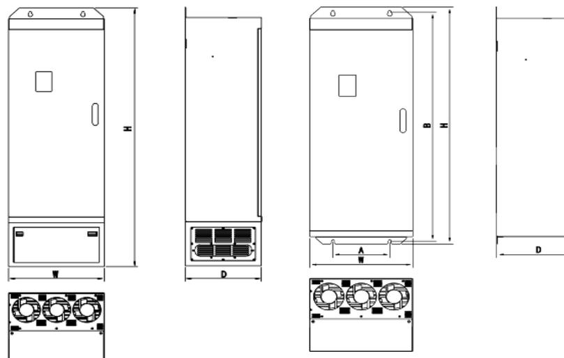
Рис. 1.7 Размеры преобразователей 132-315 кВт
