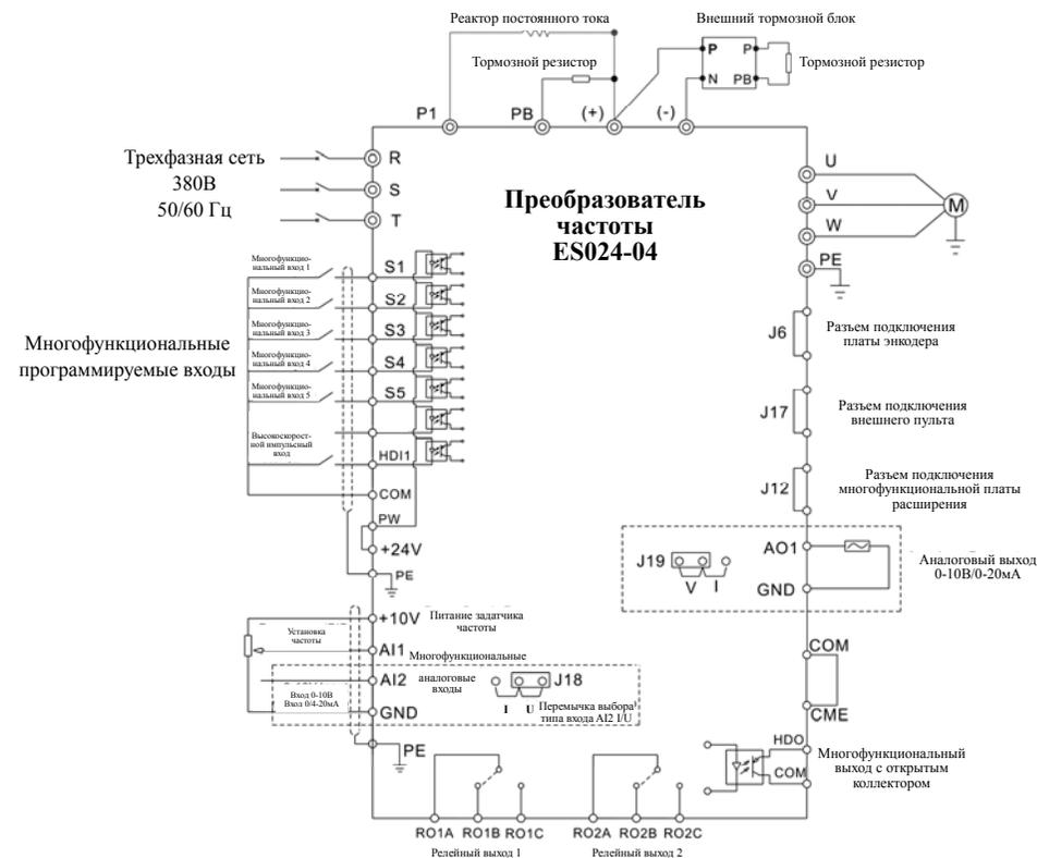
Рис. 4.8 Схема подключения
