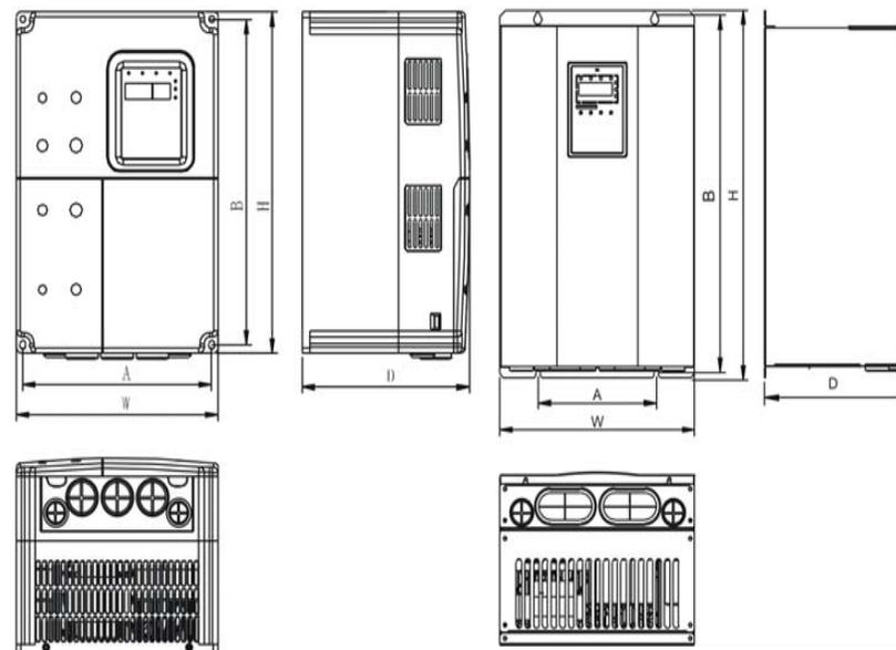
Рис. 1.5 Размеры преобразователей до 15 кВт
